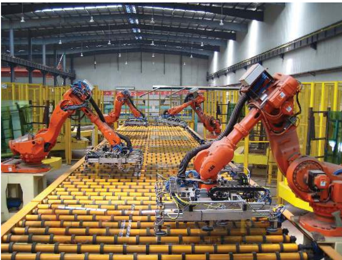
Gambar 4.19 Alat produksi gelas dengan teknologi robot
