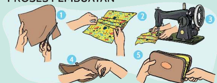
Gambar 4.10 Proses pembuatan produk kerajinan dari bahan kulit sintetik.
