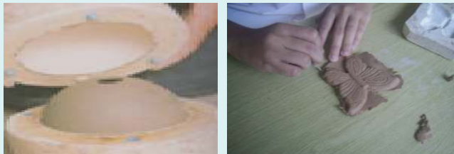
Gambar 1.21 Teknik cetak kering dan cetak cor Sumber: Kemdikbudristek/Dewi
