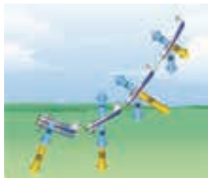
Gambar 4.28 Gaya yang terjadi ketika pesawat udara menukik tajam (Sumber: EASA Module 08 Basic Aerodynamics, 2014)
