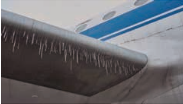
Gambar 4.14 Es yang terbentuk di permukaan sayap (Sumber: Travel + Leisure/Melanie Lieberman, 2018)
