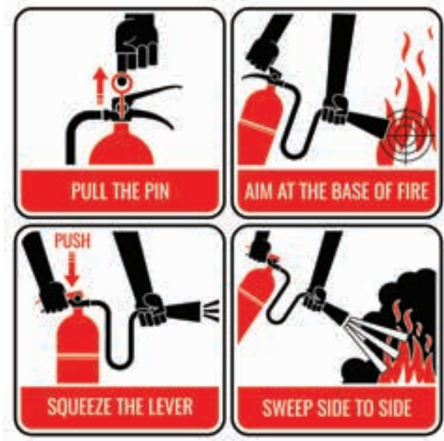
Gambar 2.27 Cara penggunaan fire extinguisher (Sumber: marineinsight.com/mohit, 2012)
