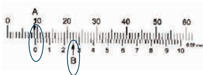
Gambar 4.5 Membaca Jangka Sorong Metrik
