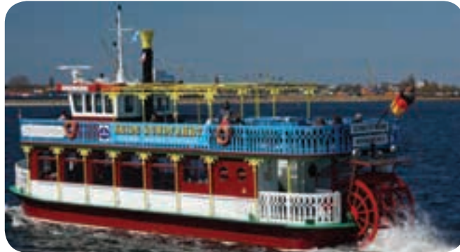
Gambar 1.21 Kapal Penggerak Paddle Wheel
