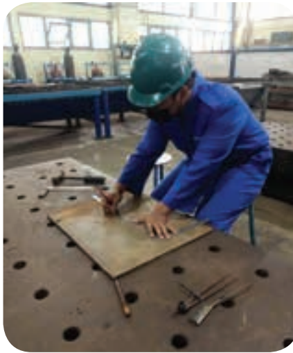
Gambar 2.4 Penandaan Material dengan Penggores dan Steel Marker
