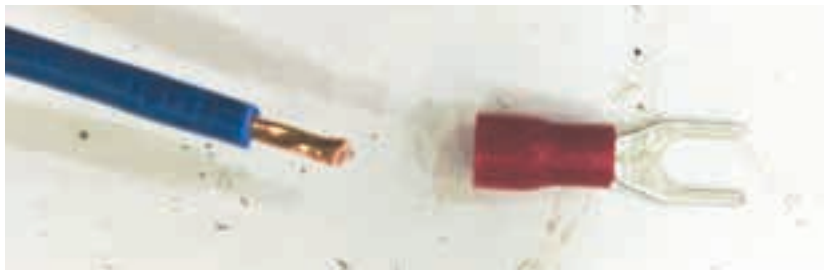
Gambar 4.34 Arah Pemasangan Kabel ke Skun
