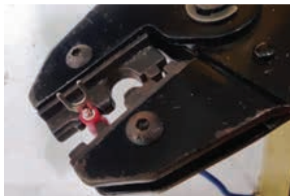
Gambar 4.35 Proses Pengepresan Skun
