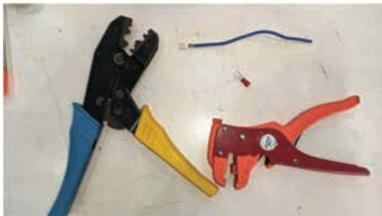
Gambar 4.32 Alat dan Bahan untuk Membuat Kabel Skun
