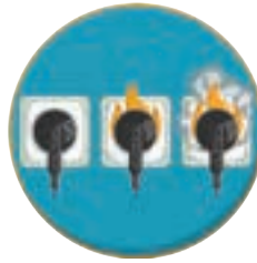
Pengkabelan yang Tidak Memadai dan Kelebihan Beban
