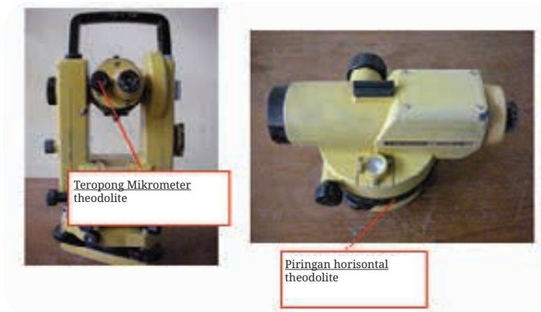
Gambar 5.10 Pringan Sudut Horizontal pada Automatic Level dan Theodolite
