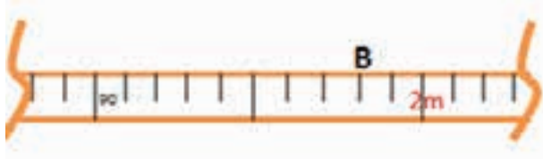
Gambar 5.42 Bacaan Pita Ukur di Titik B
