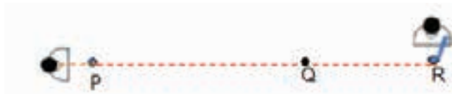
Gambar 5.47 Bidikan Memperpanjang Garis ke Titik Q dan R
