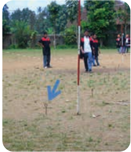
Gambar 5.15 Pengukuran Menggunakan Pen Baja
