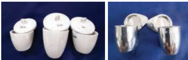
Gambar 4.23 Cawan platina dan cawan porselen untuk pengabuan.
