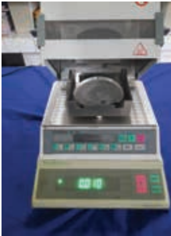
Gambar 4.33 Neraca analitik untuk kadar air ( infrared moisture balance ).
