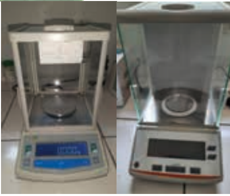
Gambar 4.32 Neraca analitik digital dengan ketelitian 0,1 mg dan 1 mg.
