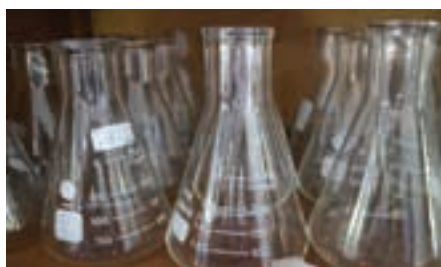
Gambar 4.4 Salah satu kegunaan labu Erlenmeyer untuk tempat mereaksikan zat.
