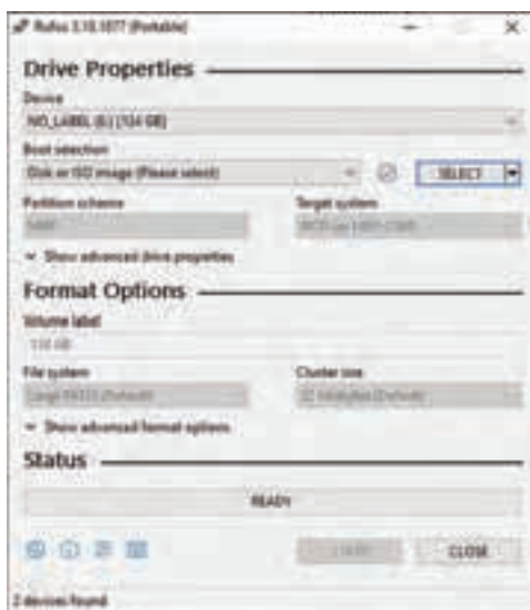
Gambar 3.36 Tangkapan Layar Pemilihan Perangkat USB Drive sebagai Bootable Sumber: Bima Laksana Putra (2022)
