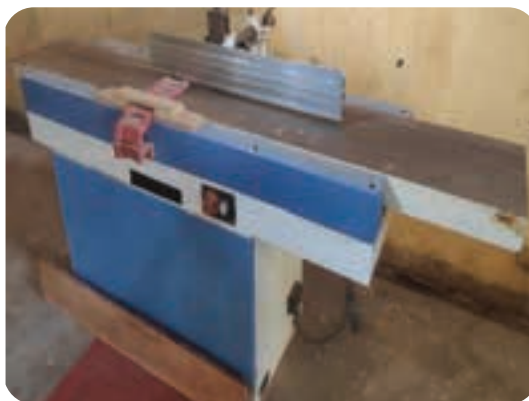
Gambar 4.49 Mesin Serut Meja Sumber : Suradi (2022)
