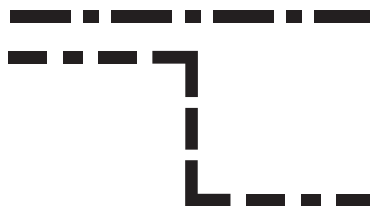
Gambar 6.40 Garis bergores tipis, yang dipertebal pada ujung-ujungnya dan pada perubahan arah.
