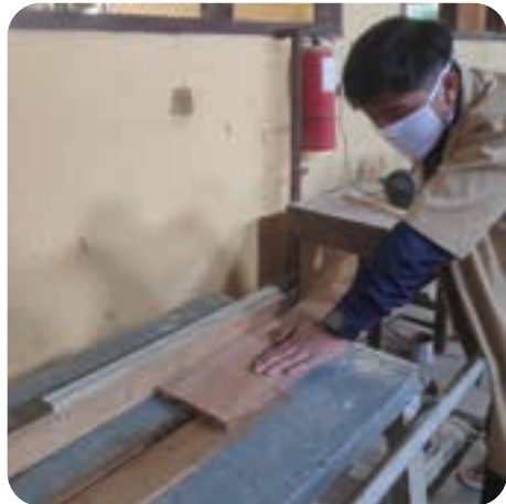
Gambar 4.71 Membelah Kayu dengan Mesin Gergaji Sirkular Meja Sumber: Suradi (2022)
