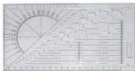
Gambar 6.18 Mal Bentuk Sumber: Suradi (2022)
