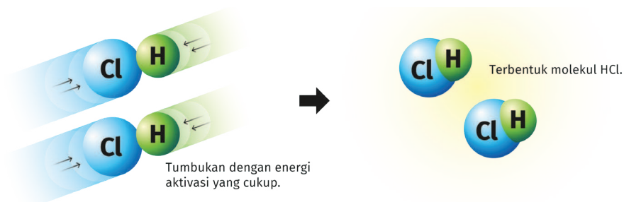
Gambar 6.3 Tumbukan molekul gas hidrogen dan gas klorin yang efektif sehingga menghasilkan reaksi dan membentuk molekul baru.
