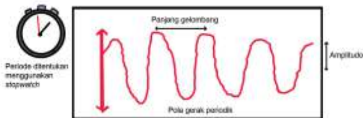
Gambar 5.1 Hasil percobaan yang diharapkan pada Aktivitas 5.1 . sumber : Alvius Tinambunan/Kemendikbudristek (2022)
