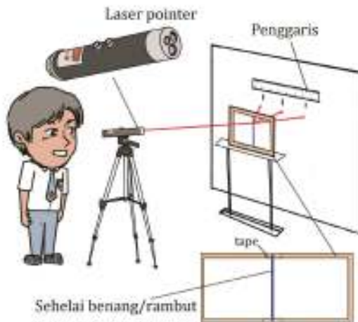
Gambar 5.11 Rangkaian percobaan difraksi celah tunggal sumber : Alvius Tinambunan/Kemendikbudristek (2022)
