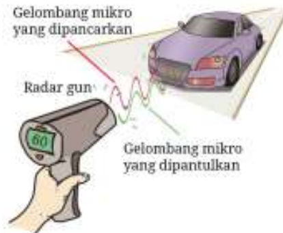
Gambar 2.10 Cara kerja radar gun sumber : Alvius Tinambunan/Kemendikbudristek (2022)
