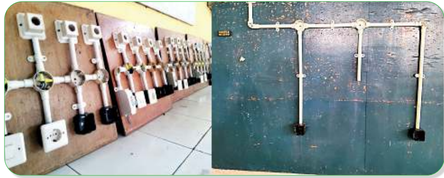
Gambar 1.6 Papan Simulasi Lampu Penerangan Sumber: Wawat N/Kemendikbudristek (2022)
