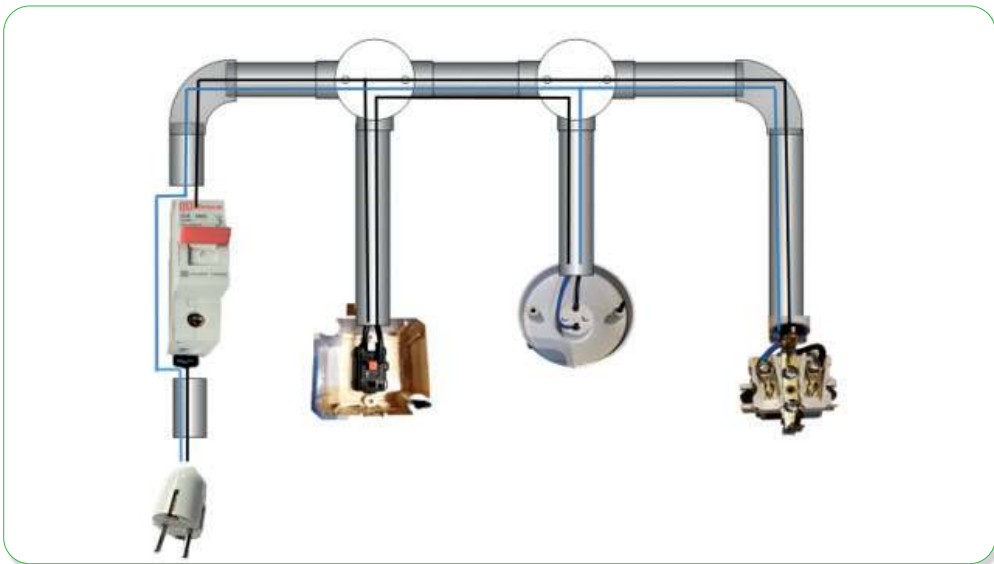
Gambar 1.7 Simulasi Rangkaian Lampu Penerangan Rumah Sumber: Wawat N/Kemendikbudristek (2022)
