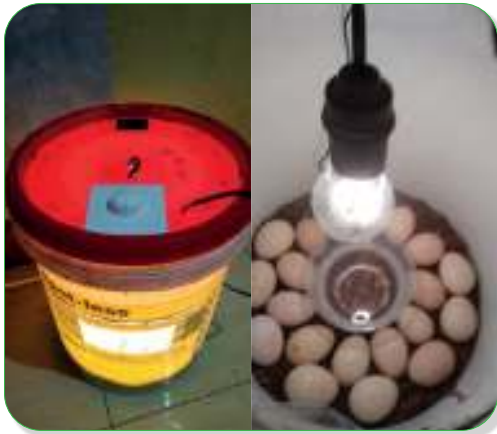
Gambar 2.1 Penetas Telur dengan Sakelar Dimmer Sumber: Wawat N/Kemendikbudristek (2022)
