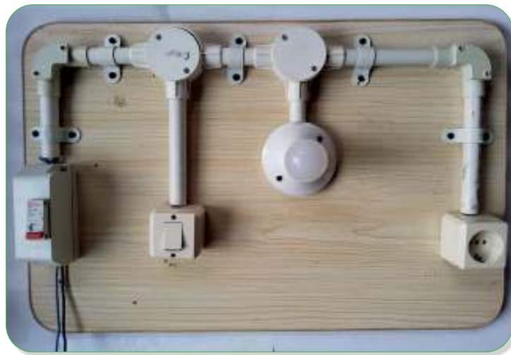
Gambar 1.1 Simulasi Lampu Penerangan Sumber: Wawat N/Kemendikbudristek (2022)
