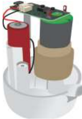
Gambar 2.15 Bagian dalam Pompa Galon Elektrik
