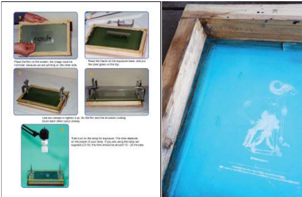
Gambar 2.23 Prinsip pencetakan gambar pada screen.
