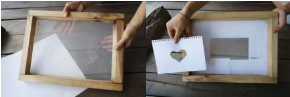
Gambar 2.19 Mempersiapkan screen agar sesuai dengan ukuran stensil (acuan gambar).
