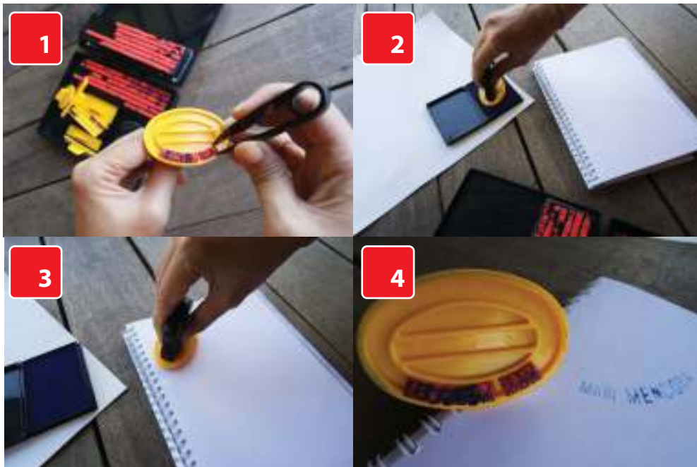
Gambar 2.9 Prinsip kerja cetak tinggi dengan huruf-huruf acuan cetak yang dapat disusun.
