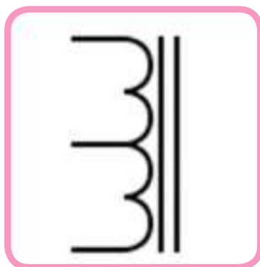
Sumber : Dokumen Kemdikbud Gambar 2.13. Simbol autotransformator
