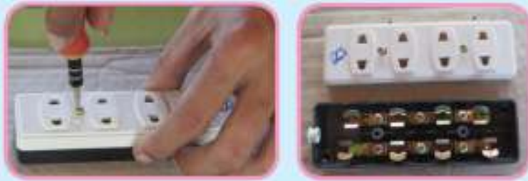
Sumber : Dokumen kemdikbud Gambar 2.34. Terminal 4 mata
