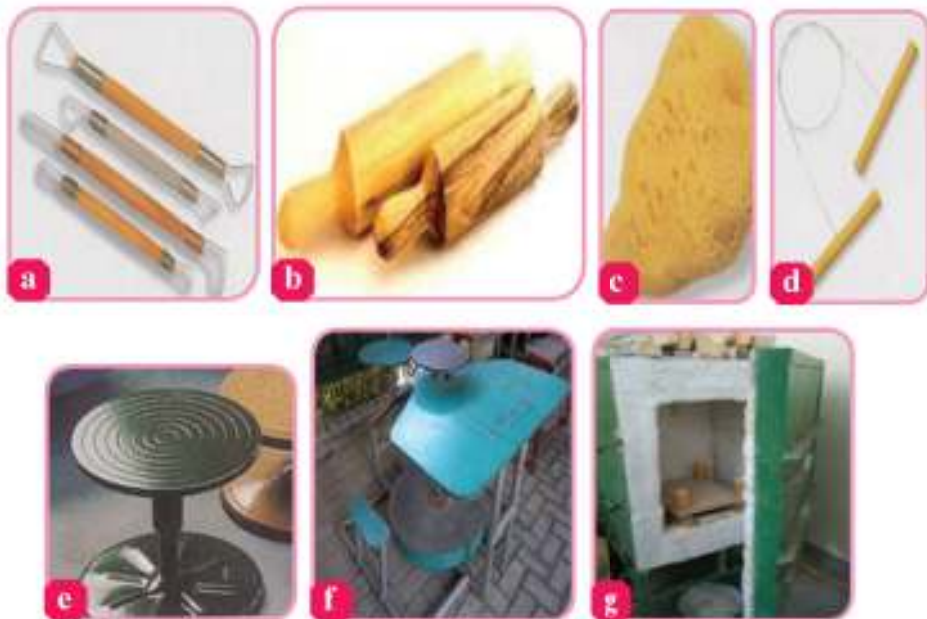
Sumber : Dokumen Kemdikbud Gambar 1.32. Alat pembuatan kerajinan keramik; a. butsir, b. rol, c. spon, d, tali pemotong, e. alat putar tangan, f. alat putar kaki, e. tungku pembakaran.
