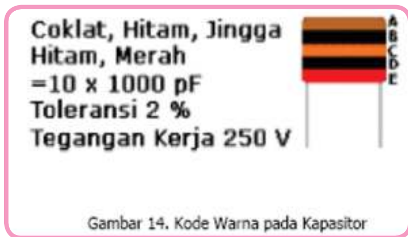
Sumber : Dokumen Kemdikbud Gambar 2.5. Kode warna pada kapasitor
