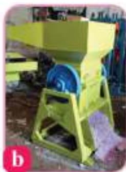
Gambar 1.26. Alat kerajinan dari plastik; a. Gunting, b. Alat penggiling plastik.
