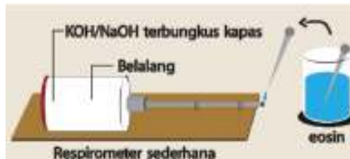
Sumber: Dok. Kemdikbud Gambar 5.24 Respirometer sederhana
