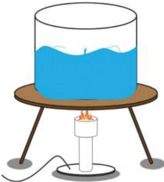
Sumber: Dok. Kemdikbud Gambar 4.19 Arus konveksi pada air yang dipanaskan.
