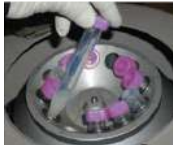
Sumber: Dok. Kemdikbud Gambar 3.16 Alat Sentrifugasi
