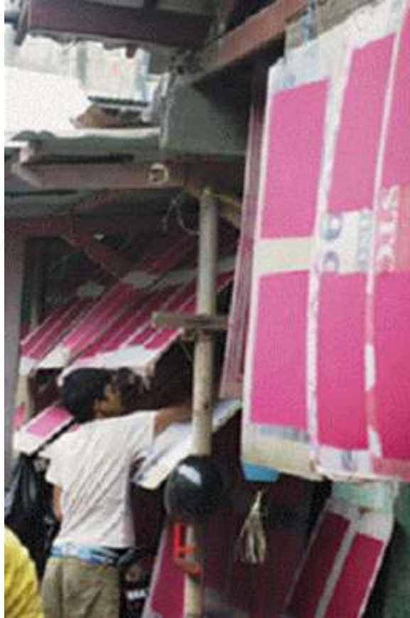
Sumber: Helmy Noermawan / JICA Gambar 3.2: Kertas yang telah dicetak dijemur di bawah sinar matahari agar menghasilkan kualitas yang bagus
