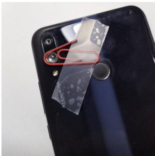
Modifikasi kamera smartphone menjadi mikroskop
