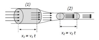
Pada gambar di atas, Massa fluida yang masuk pada penampang 1 sama dengan massa fluida yang masuk pada penampang kedua maka
