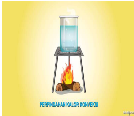
Gambar 2. Perpindahan Kalor secara Konveksi
