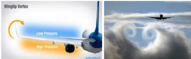
Gambar 6. Perbedaan tekanan udara pada sayap pesawat Sumber : https://www.dream.co.id
