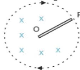
Batang konduktor OP yang panjangnya 40 cm berputar dengan frekuensi 4 Hz di dalam medan magnetik 0,3 T. Tentukan besar GGL induksi yang terjadi pada batang konduktor OP!
