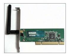
Wireless card merupakan salah satu perangkat jaringan yang dapat menghubungkan dua device secara nirkabel atau tanpa menggunakan media kabel. Dengan menggunakan wireless card, dua komputer atau lebih dapat saling terhubung melalui jaringan wifi, tanpa harus menggunakan kabel jaringan. Laptop saat ini kebanyakan sudah dilengkapi dengan wireless card didalamnya, jadi kita tidak perlu membelinya secara terpisah, berbeda dengan komputer yang terlebih dahulu kita harus membelinya secara terpisah.
