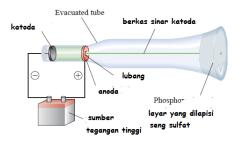
Hampir semua udara di dalam tabung dikeluarkan sehingga tekanan udara dalam tabung kira-kira 0,01 mmHg. Beda potensial V mempercepat partikel-partikel bermuatan negative keluar dari katoda menuju anoda. Kecepatan partikel keluar dari katoda v dapat dihitung dari fakta bahwa energy potensial listrik yang diterima partikel bermuatan e dari beda potensial V, yaitu Ep = e V, diubah menjadi energy kinetik elektron keluar dari katoda yaitu  $Ek = \frac{1}{2}$  m  $v^2$ .
