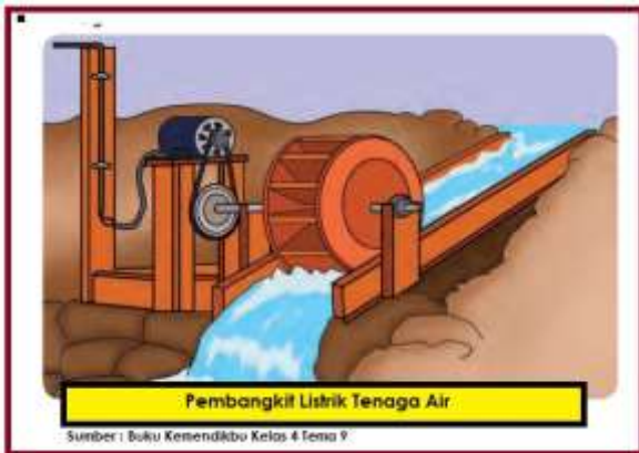
Gambar 2. Pembangkit listrik tenaga air
