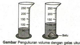
Gambar Pengukuran volume dengan gelas ukur
