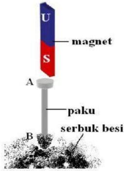
2. Cara pembuatan magnet pada gambar di samping adalah ....
