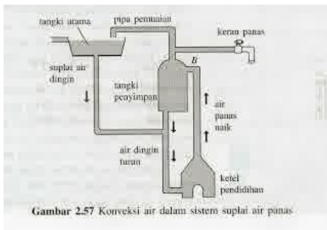
gambar 2. Konveksi air dalam sistem suplai air panas
