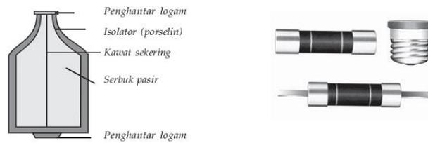
(a) Skema Sekering (b) Macam-macam Bentuk Sekering
