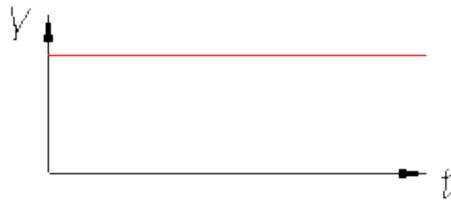
Gambar 23. Hubungan Tegangan Terhadap Waktu Pada Sumber Tegangan DC
