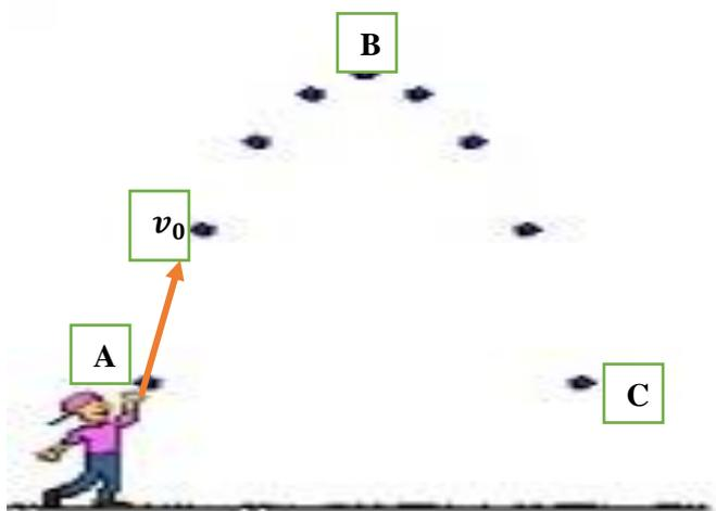
Seorang anak melemparkan sebuah benda dengan kecepatan awal  $v_0$  seperti pada gambar. Pada saat benda mencapai titik B atau titik tertinggi. Pernyataan berikut yang tepat mengenai kecepatan benda saat berada pada titik B adalah....
