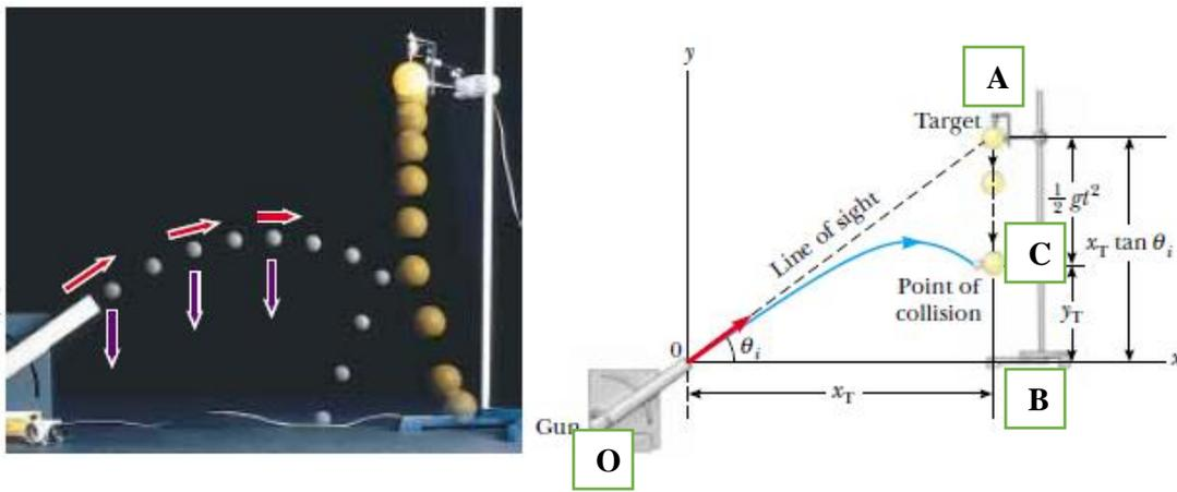
Sebuah benda kecil,  $m$ , dijatuhkan dari titik A yang jarak tegak lurus nya 30 m di atas B. Pada saat yang sama, sebuah proyektil ditembakkan dari titik O dengan laju 25 m/s dan diarahkan ke titik A. Titik C berada di ketinggian 10 m di atas B. Jika jarak OB adalah 40 m maka:
