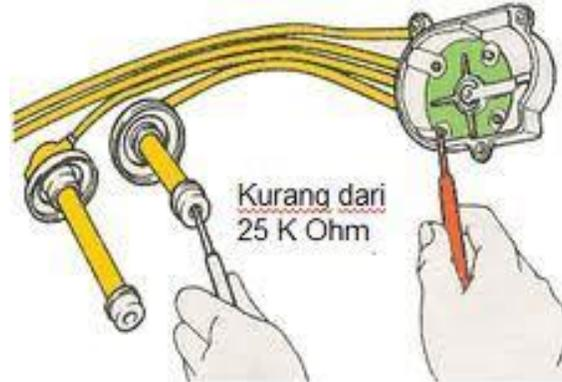
*Mengukur tahanan kabel tegangan tinggi/kabel busi*
