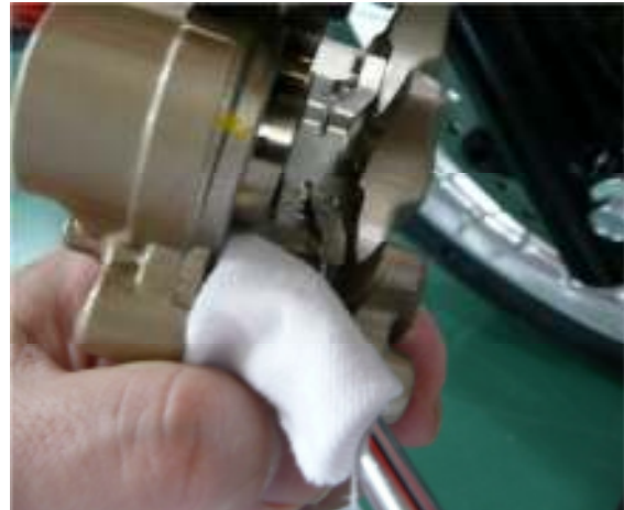
Pelepasan Brake Caliper dari Front Fork
