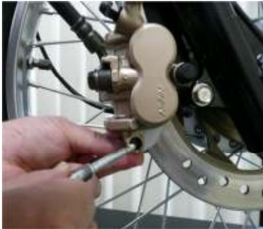
Pelepasan Brake Caliper dari Front Fork
