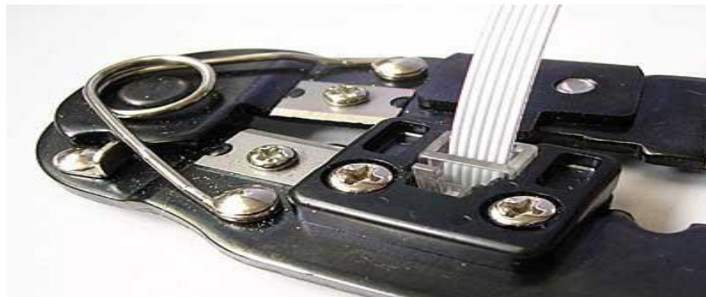
Gambar 9 : Kabel UTP di Crimping/diJepit
