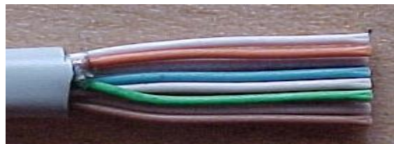
Gambar 7 : Kabel UTP yang sudah diratakan ujungnya
