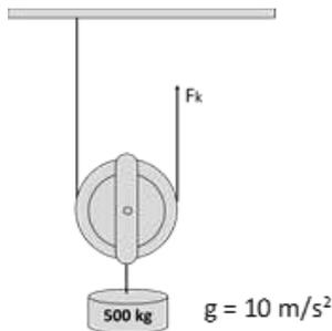
Berdasarkan ilustrasi gambar disamping, besar gaya minimal untuk mengangkat beban adalah....
