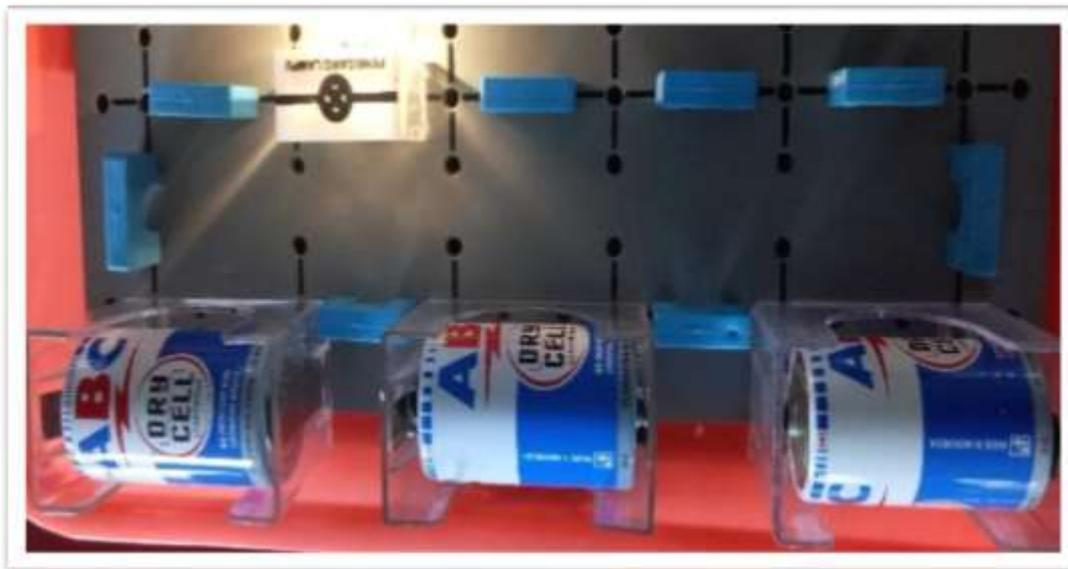
Ulangi langkah 1 dan 2 dengan menggunakan 3 baterai yang disusun secara seri
