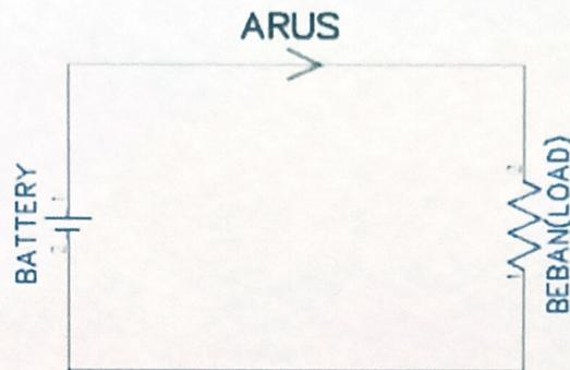
Pada rangkaian diatas tampak sebuah rangkaian sederhana dengan satu sumber tegangan berupa battery dan sebuah beban (load) yang dipasang pada sumber tegangan tersebut. Karena diberi beban, maka terjadi kuat arus yang mengalir pada rangkaian.
