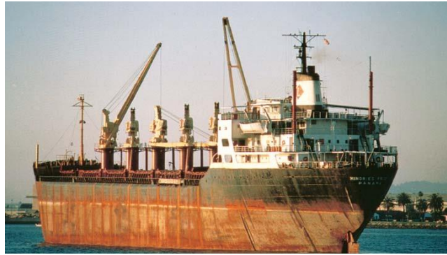
Gambar 2. Korosi pada permukaan badan kapal (Sumber: Chang, 2010)
