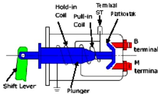
Aliran arus listrik yang mengalir pada pada motor starter pada saat pinion gear dan ring gear berkaitan penuh melalui .....
