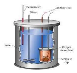
Salah satu kegunaan yang penting dari kalorimeter adalah dalam penentuan kalor jenis suatu zat. Pada teknik yang dikenal sebagai "metode campuran", satu sampel zat dipanaskan sampai temperatur tinggi yang diukur dengan akurat, dan dengan cepat ditempatkan pada air dingin kalorimeter. Kalor yang hilang pada sampel tersebut akan diterima oleh air dan kalorimeter. Dengan mengukur suhu akhir campuran tersebut, maka dapat dihitung kalor jenis zat tersebut.
