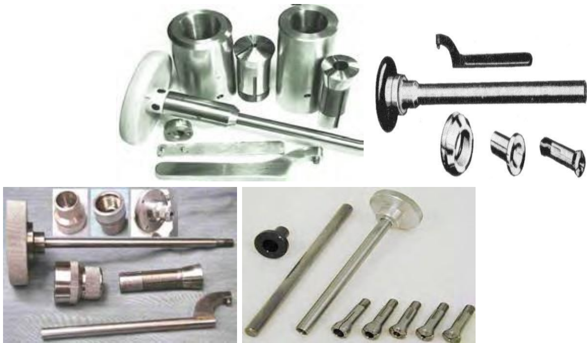
Gambar 1.21. Cekam kolet dengan batang penarik
