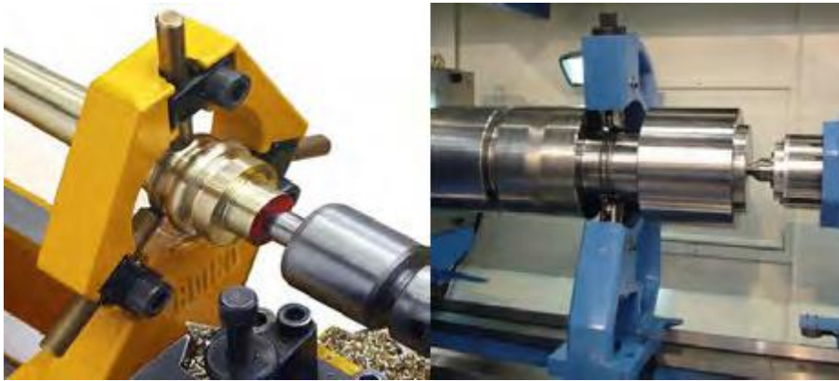
Gambar 1.33. Penggunaan penyangga tetap
