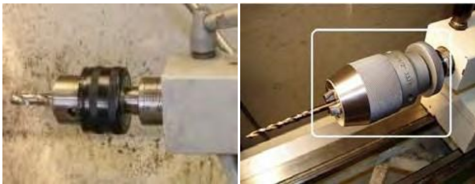
Gambar 1.38. Pemasangan cekam bor
