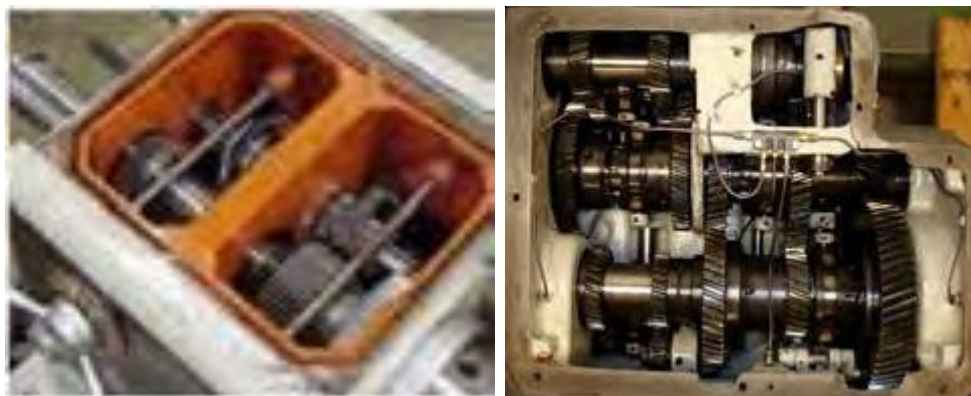
Gambar 1.5. Gear box pada kepala tetap
