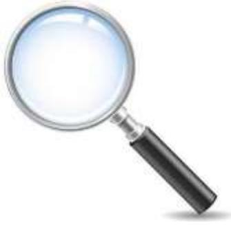
Cahaya yang melewati lup membelok ke dalam untuk mengumpul di sebuah titik focus pada sisi kedua lensa. Benda yang diamati diletakkan di ruang 1 sehingga menghasilkan bayangan maya, terbalik
