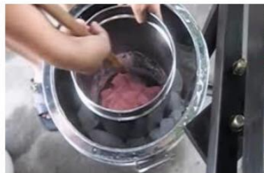
Gambar 3. Contoh penerapan sifat koligatif larutan penurunan titik beku pada cairan pendingin untuk pembuatan es puter/es lilin
