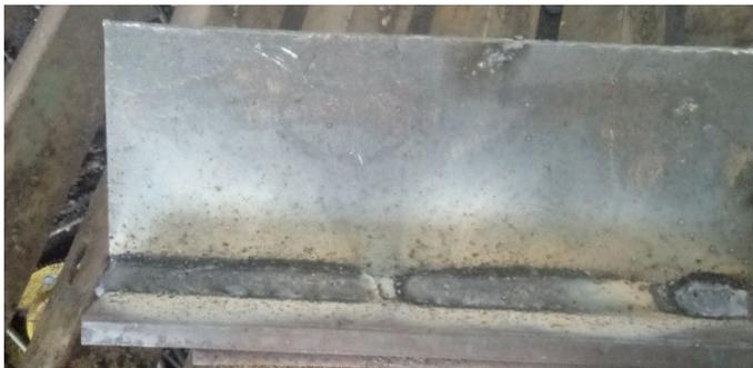
Gambar 5. Mengelas las catat atau tack weld
