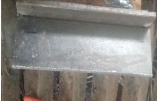
Gambar 3. Mengelas las catat atau tack weld
