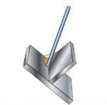
Gambar 4 posisi pengelasan 1F
