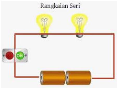
Masih ingatkah kamu yang dimaksud dengan rangkaian listrik seri ? Rangkaian listrik seri adalah rangkaian listrik yang pada proses pemasangannya dilakukan dengan cara berurutan. Besar daya yang akan diterima oleh setiap beban adalah sama. Secara umum Bisa dijelaskan bahwa sebuah rangkaian listrik bagian kabel dan beban atau komponen dipasang dengan cara sejajar dan juga berurutan. Model dari rangkaian seri ini tentunya sangat berbeda dengan rangkaian listrik paralel.
