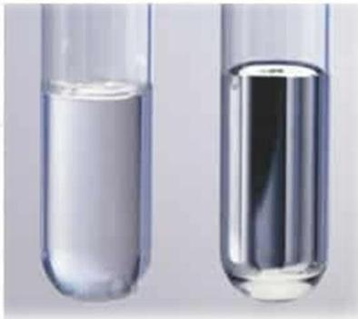
Gambar 5. Meniskus cembung dan cekung
