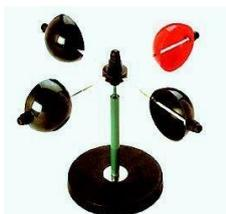
4. Anemometer digunakan untuk mengukur kecepatan angin. Pada alat ini terdapat beberapa mangkuk untuk menerima tiupan angin. Ketika angin bertiup, angin mengenai mangkuk tersebut sehingga mangkuk berputar. Putaran mangkuk dihubungkan dengan alat pencatat kecepatan. Kecepatan mangkuk berputar tergantung pada kecepatan angin bertiup.
