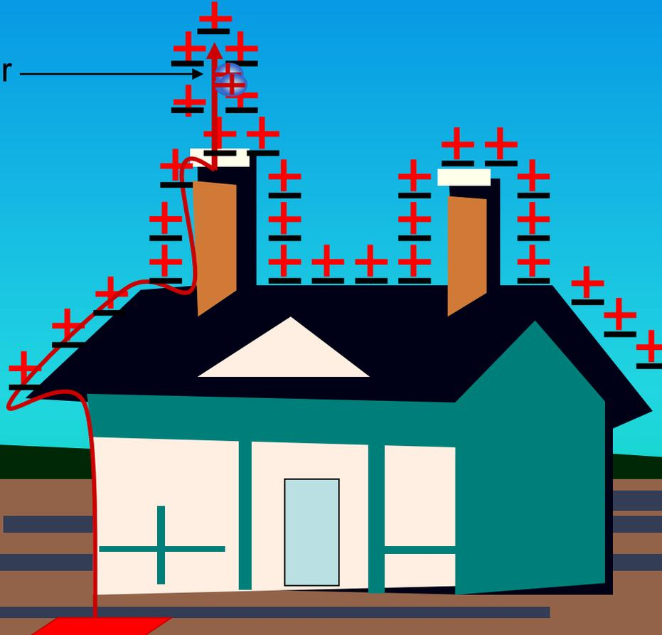
Ketika rumah terinduksi oleh awan yang bermuatan sehingga atap rumah dan penangkal petir menjadi bermuatan positif karena penangkal petir terbuat dari bahan konduktor yang ujungnya runcing maka udara disekitar penangkal petir akan terionisasi ion negatif akan ketarik penangkal petir dan dialirkan kebumi sedangkan ion positif akan ketarik awan dan menetralkan awan .
