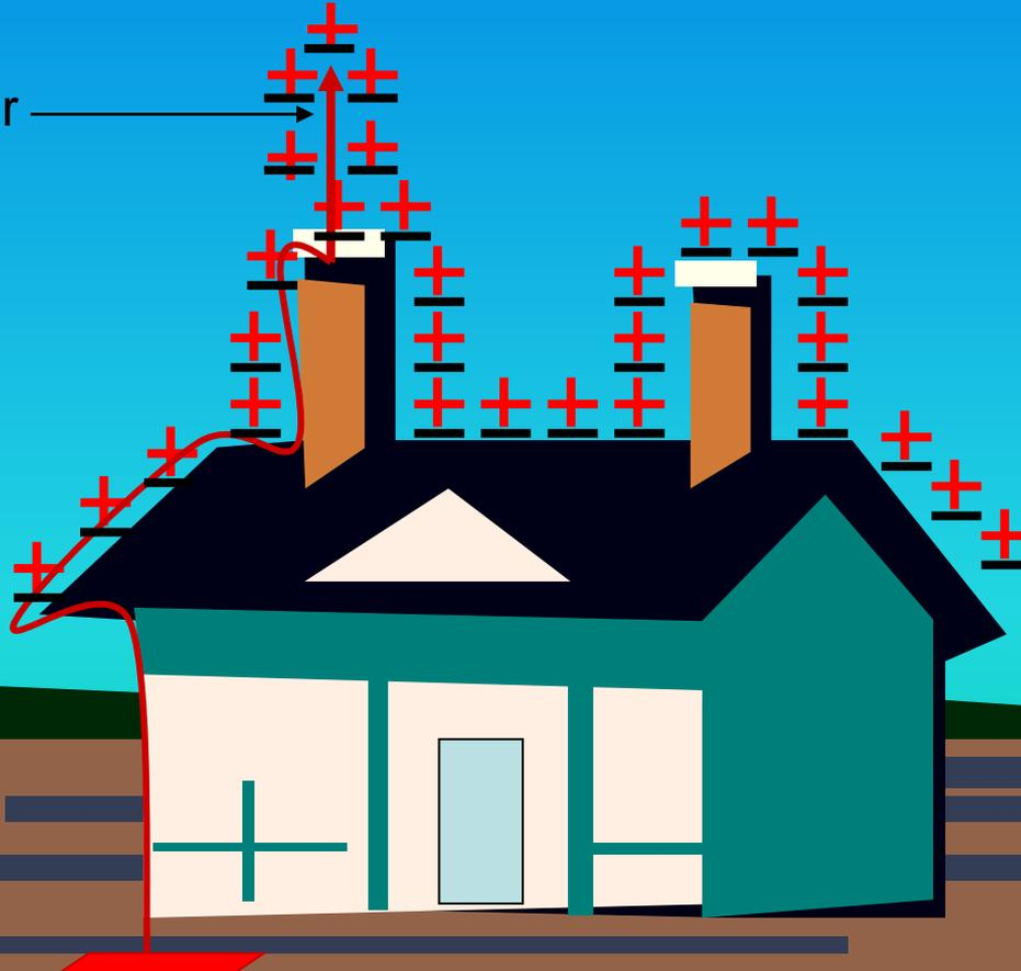
Ketika rumah terinduksi oleh awan yang bermuatan sehingga atap rumah menjadi bermuatan positif maka muatan – muatan negatif awan mengalir dari awan ke bumi melewati penangkal petir, karena penangkal petir terbuat dari bahan konduktor yang baik maka ketika dilewati muatan listrik negatif dari awan tidak menyebabkan kerusakan.
