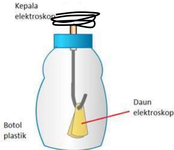
**c. Menguji cara kerja Elektrooskop**
