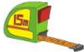
Meteran gulung disebut juga meteran saku. Meteran gulung berfungsi untuk mengukur panjang benda yang lebih dari satu meter. Meteran ini biasa digunakan pekerja bangunan atau tukang kayu.
