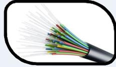
Fiber Optik (*Fiber Optic*) adalah sebuah kabel terbuat dari kaca atau plastik yang digunakan untuk mentransmisikan sinyal cahaya dari sumber ke tempat tujuan. Cahaya yang terdapat dalam fiber optik sulit keluar karena indeks bias kaca lebih besar dibandingkan indeks bias udara.
